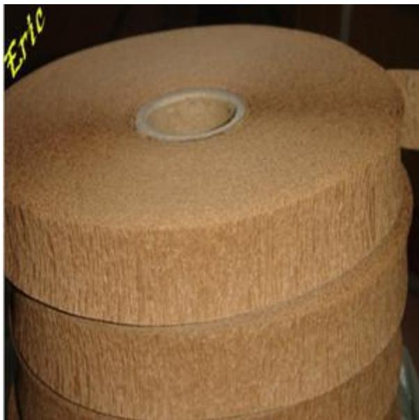
绝缘皱纹纸是一种应用普遍的电工材料，而且在各种不同的电工设备中，对绝缘材料的性能要求也有所差异。比如说高压电工装置中的高压电机、高压电缆等用的绝缘材料要求有高的击穿强度和低的介质损耗；而低压电器则以机械强度、断裂伸长率、耐热等级等作为主要要求。如何防止绝缘皱纹纸板老化，您应该注意以下五点：1. 防止绝缘皱纹纸板处于高温的环境中，因为环境温度每升高8℃□绝缘皱纹纸板寿命将减半。2. 要避免光照和辐射，因为光照和辐射会改变绝缘的分子结构，降低绝缘强度；3. 避免接触腐蚀性化学气体或液体，因为这些会使绝缘皱纹纸板绝缘性能变性，降低绝缘强度；4. 运输时应使用有防护措施的洁净运输工具，不应与有污染的
